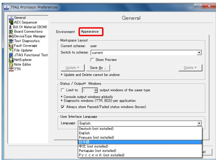
(3) 以下の画面が表示されますので、OK ボタンをクリックし、ProVision を再起動すると日本語表示が適用されます。
