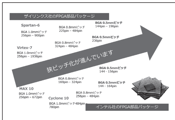
図1 FPGA 部品 パッケージの小型化
