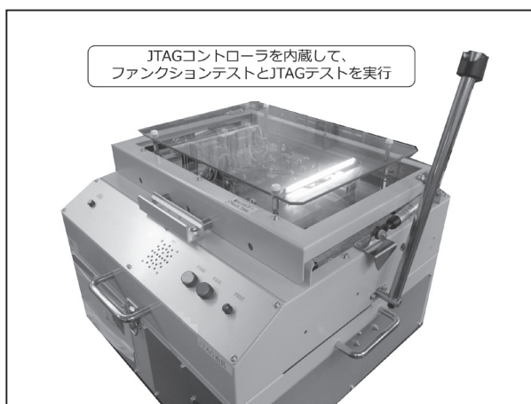
図6 JTAGテストを組み込んだファンクションテスタ
