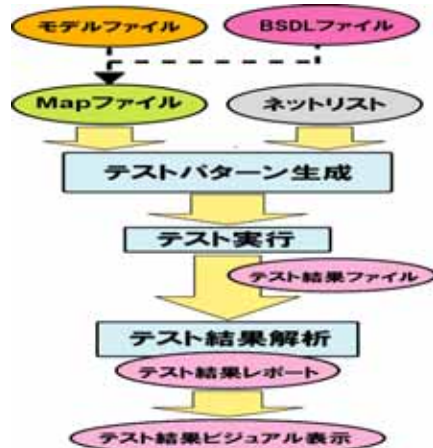
図 3. JTAG テストのテストフロー
