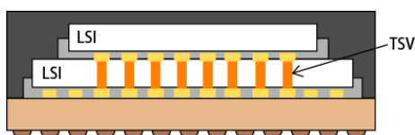
図 1. TSV(Through Silicon Via)チップ構造
