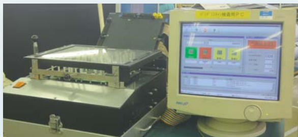
量産工程で使用されているJTAGテストツール
