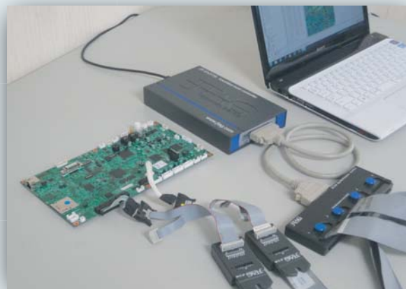
JTAGテストは、従来検査よりも簡単な接続でBGAが搭載された高密度実装基板に対して効率のよい検査を実現できる。
