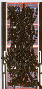
T従来の故障挿入システムでは、手動で障害を挿入するためのパッチパネルが使われています。
